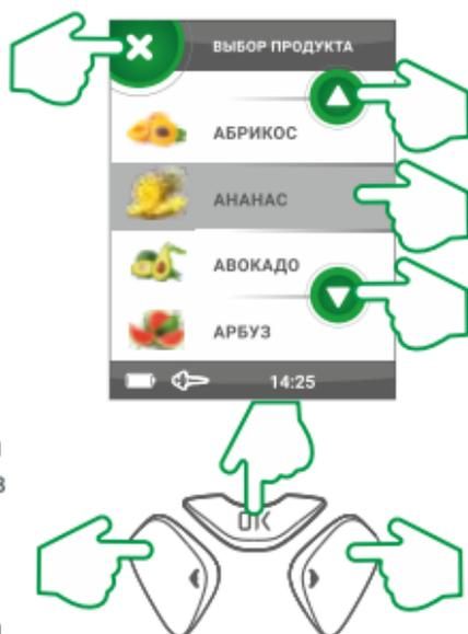
После выбора продукта производится калибровка зонда. Во время калибровки зонд не должен быть в продукте. После калибровки на экране отобразится наименование продукта, норма содержания в нем нитратов в мг/кг и рекомендация о вводе зонда в продукт. Необходимо ввести зонд в продукт, дождаться стабилизации температуры (значение выводится в верхнем правом углу экрана) и нажать пиктограмму «ИЗМЕРИТЬ» на дисплее или нажать кнопку «ОК» на приборе.
