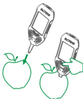
Можно нажать пиктограмму «ИЗМЕРИТЬ» сразу, не дожидаясь стабилизации температуры, так как прибор в любом случае выведет на экран результат измерения. Если температура продукта была комнатной, то результат будет достоверным. Если же продукт был взят из холодильника, то результат будет менее достоверным. В таком случае можно дождаться стабилизации температуры и нажать пиктограмму «Повторить». Тогда прибор выведет более точный результат с учетом температуры продукта.
