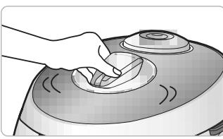
В) Поверните рычаг затвора в положение «**ЗАКРЫТО**», на панели загорится красный индикатор.
