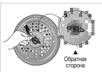
Для очистки крышки, снимите крепёжную резиновую ручку. Сначала оттяните 2 резиновых выступа ручки с обратной стороны крышки, затем снимите ручку, потянув её с лицевой стороны. Снимите резиновую прокладку.
