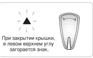
Б) Закройте крышку мультиварки до щелчка замка крышки.
