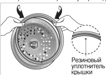
Для установки резинового уплотнительного кольца на съемную крышку, удерживая и натягивая кольцо на края крышки, поворачивая его.
