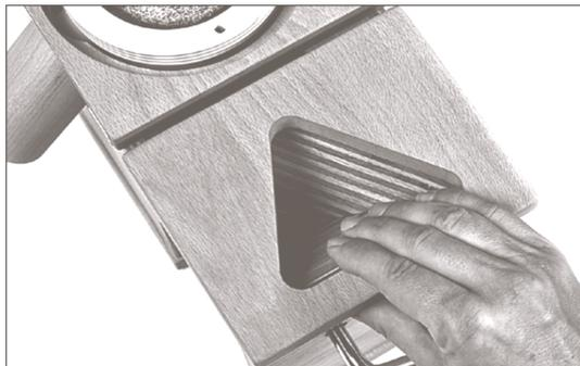
4. Для того, чтобы открутить ручку от корпуса мельницы, заблокируйте валики хлопницы с помощью металлической пластины, которая идет в комплекте.
