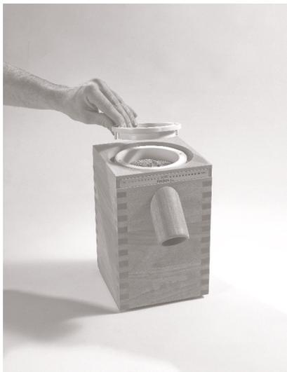
5. Установите цилиндр просеивателя из органического стекла на нижнюю часть просеивателя. 2 шарика должны встать в углубления на цилиндре. При необходимости, покрутите цилиндр в разные стороны, чтобы он встал на место;
