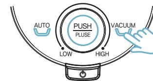
Если возникнет ошибка, лампочки вакуумирования и импульсного режима будут мигать одновременно со звуком. Это прекратится после нажатия на кнопку включения. Проверьте соединение между вакуумным стаканом, основным корпусом и вакуумным...
