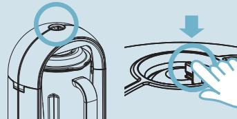
\*Если ошибка произошла в то время, когда работа была еще не окончена, это может привести к ослаблению уплотнителя. Нажмите на верхушку вакуумного клапана на основном корпусе, когда начнется процесс вакуумирования.
