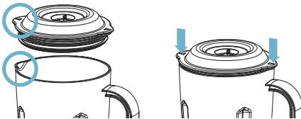
3. Поверните вакуумный стакан по часовой стрелке до тех пор, пока ручка не встанет в положение «Lock» с передней стороны.
