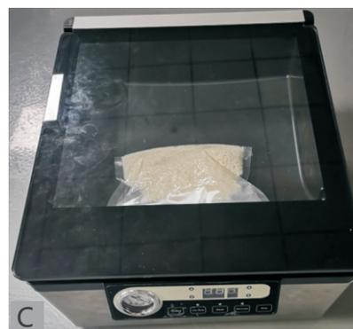
Закройте прозрачную крышку для работы в режиме вакуумации
