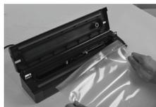
6. После остановки запайки поднимите крышку и извлеките пакет. Теперь пакет готов для вакуумирования.
