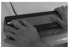
3. Закройте крышку. Хорошо надавите на крышку обеими руками по бокам крышки. Удерживайте кнопку "Start" на аппарате, чтобы активировать функцию «вакуум + запайка». Примечание: вакуумный упаковщик не будет работать, если крышка закрыта неправильно или в случае, если открытый конец пакета был помещен в вакуумную камеру.
