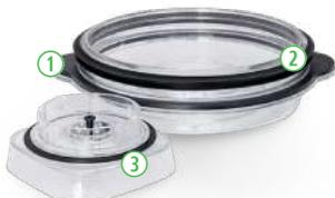
1. Если вакуумный насос проработал более минуты, но вакуумирования не произошло, проверьте все 3 уплотнителя на крышке чаши. ① верхний уплотнитель, ② большой уплотнитель на основной крышке и ③ уплотнитель маленькой крышки – они должны плотно прилегать к пластиковым деталям.
