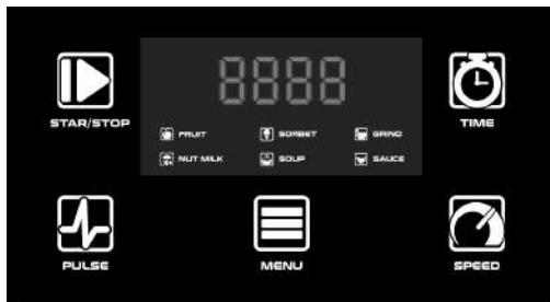
1. Блендер оснащен электронной тач-панелью. В левом верхнем углу расположена кнопка питания Старт/Стоп, ниже находится кнопка режима Pulse. Кнопка таймера (доступны 6 значений) расположена в правом верхнем углу.
