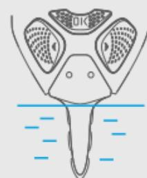
По окончании процесса измерения на дисплей выводится информация об уровне твердых веществ в воде.
