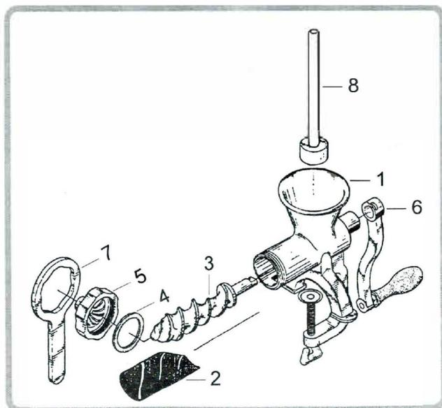
Для правильной сборки соковыжималки зафиксируйте ее на краю стола с помощью винтового зажима и разложите на столе все части прибора строго в том порядке, что обозначен на рисунке.
