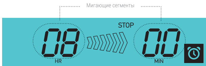
Рисунок 16. Настройка времени выключения устройства
