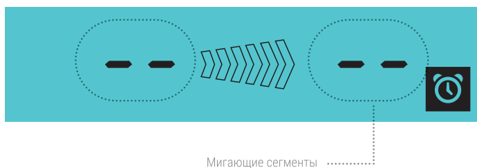
Рисунок 12. Индикация режима ожидания на ЖК-дисплее при активном таймере
